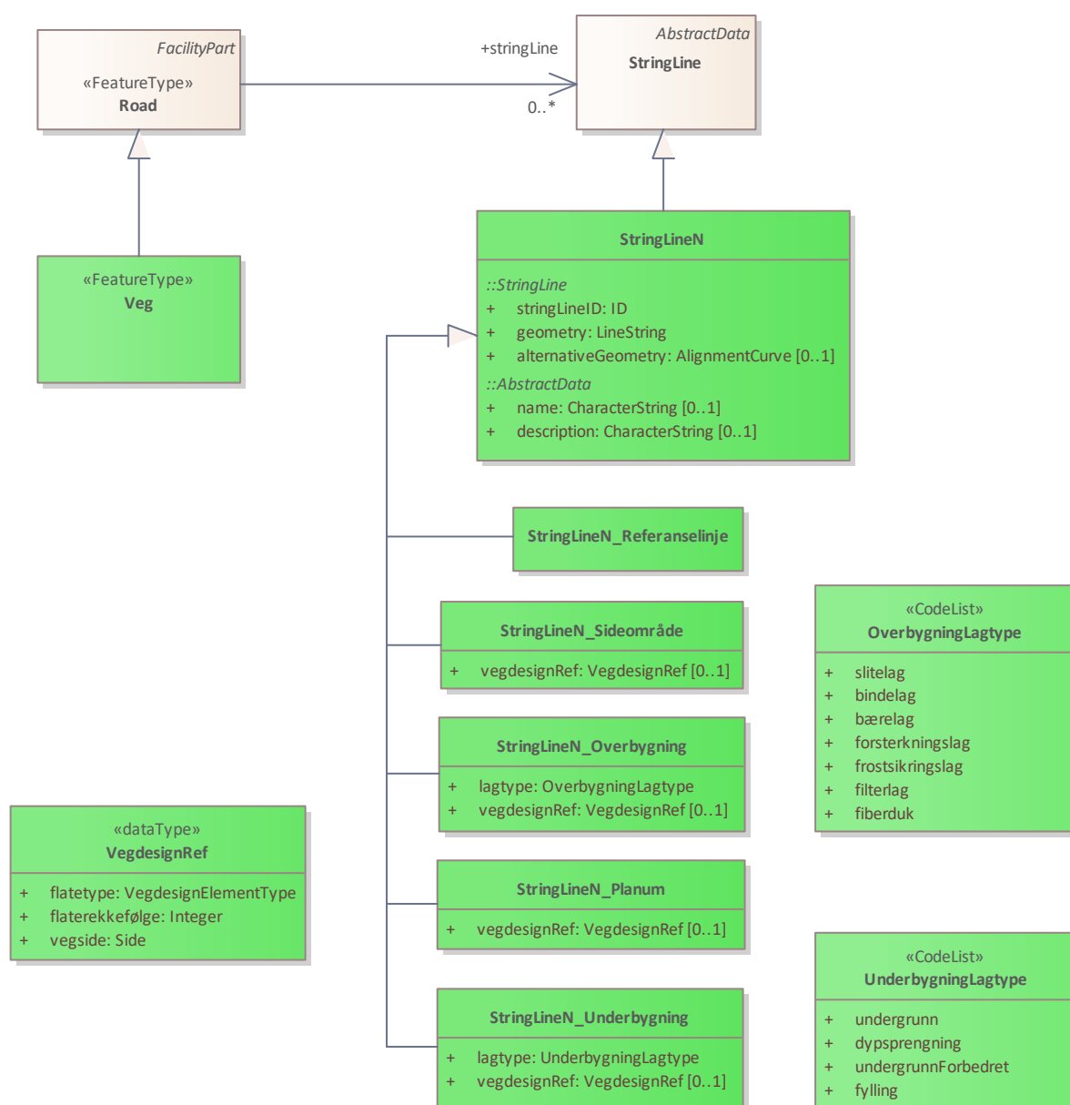
Figur 6 Veg med Stringline
