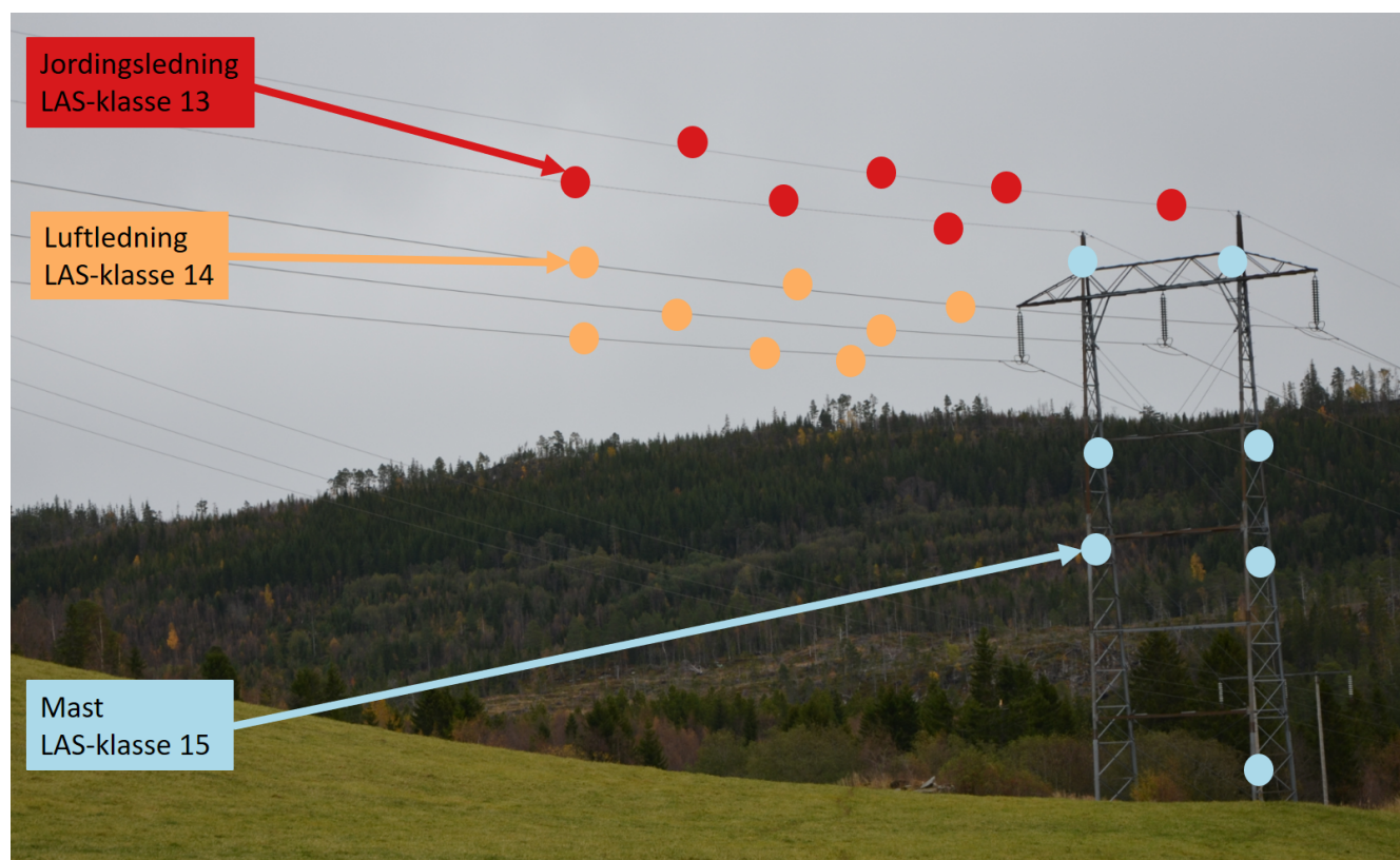
Figur 1. Oversikt over LAS-klasser som benyttes for klassifisering av punkt på ledningsobjekter.
