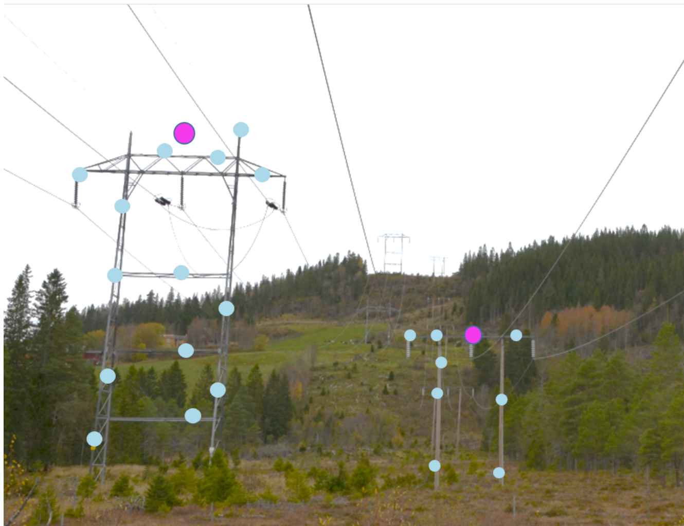
Figur 12. Blå punkt er punkt fra laserskanning som er klassifisert som mast. Magenta punkt er det punktet som skal registreres/genereres for mast
