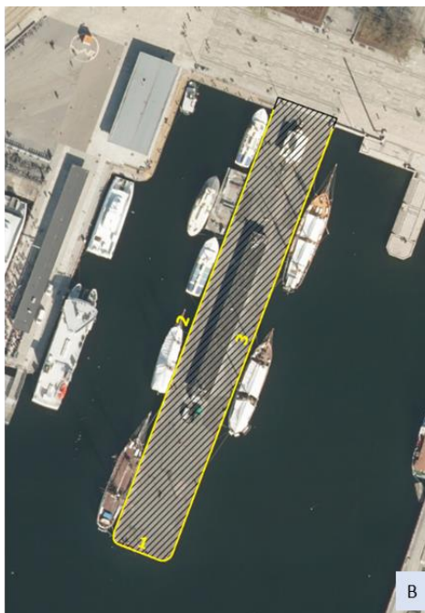
Bilde 11. A. Kaien/Kaifronten er ofte i praksis ikke en skarp 90 graders knekk, men kan ha en skråkant eller annen form for avrundning. Kaifronten måles inn på toppen, langs den ytterste linjen, før konstruksjonen skrår eller avrundes. Se linje inntegnet med rødt i bildet. Foto: Kartverket, 2021. B. Flere kaifronten (nr.1 til 3) kan dele ett kaiområde (skravert område).
