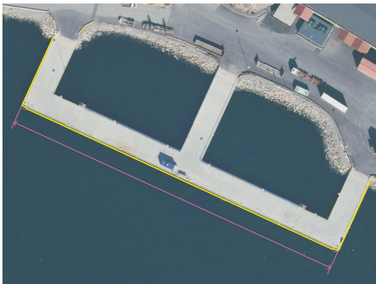
Bilde 10: Kaifront er lagt inn med gul linje. Kailengden måles opp på den delen av kaifronten som egner seg for anløp av skip. Høydereferanse: Topp. Norkart, 2020.
