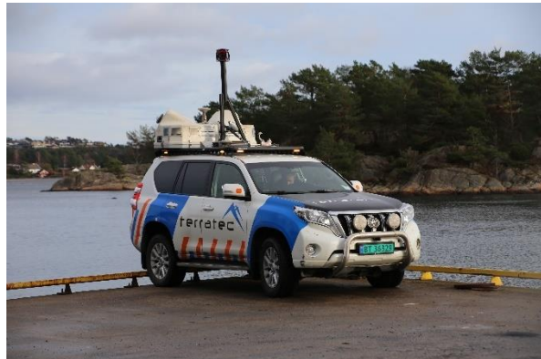
Bilde 18. Innmåling med mobile mapping i Kristiansand havn (Foto: Norkart, 2020).
