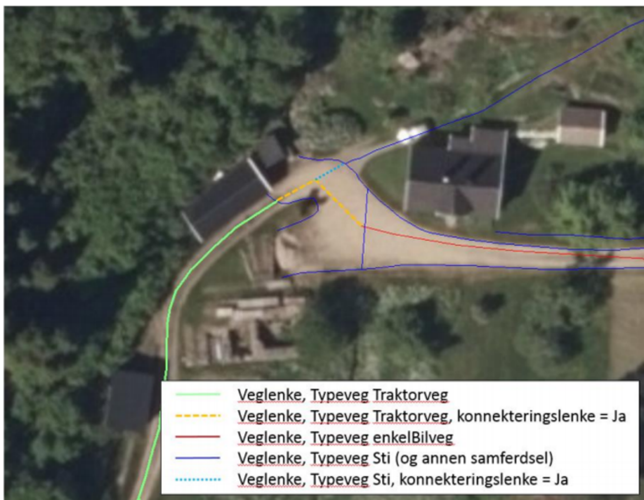
Figur 7. Eksempel på bruk av konnektierungslenke over tun i FKB-TraktorvegSti. Konnektierungslenker skal registreres fotogrammetrisk.
