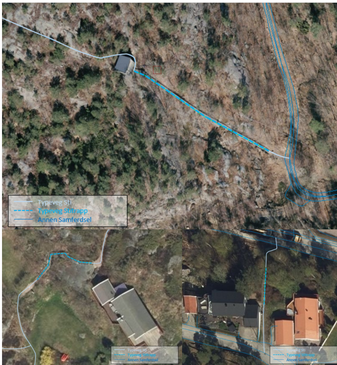
Figur 4. Eksempel på registrering av typeveg "stitrapp" i forbindelse med typeveg "sti" og andre samferdselsobjekter.
