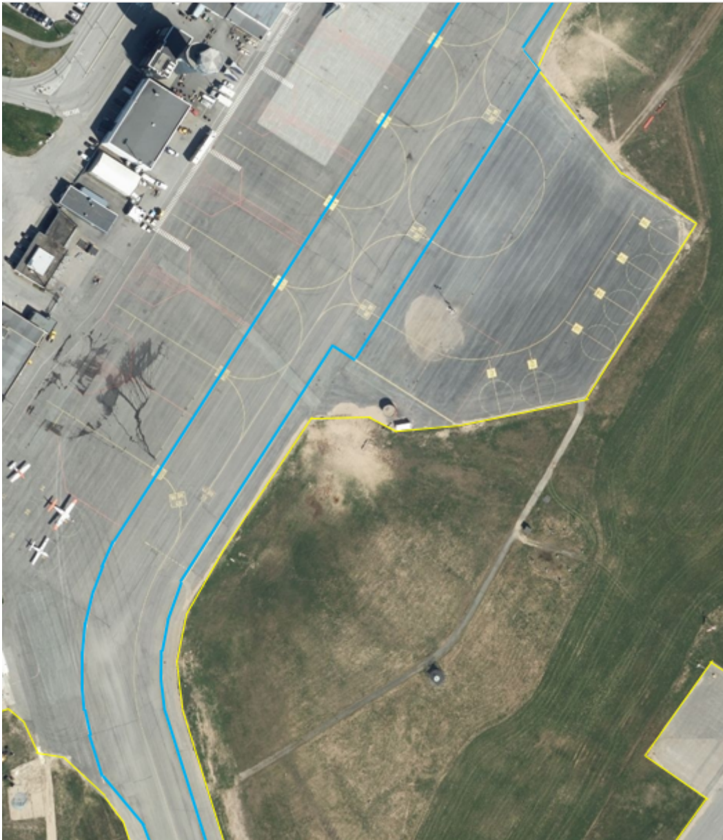
Figur 9. Eksempel på taksebanegrense er markert med blått i bildet. Taksebanegrense skal registreres etter markering alternativt dekkekant hvis markering mangler. Rullebane er markert i rødt i bildet. Annen vegsituasjon (gult i bildet) på lufthavnen som ikke beskrives av andre objekttyper skal registreres som AnnetVegarealAvgrensning. Se mer om dette i registreringsinstruksen for FKB-Veg.
