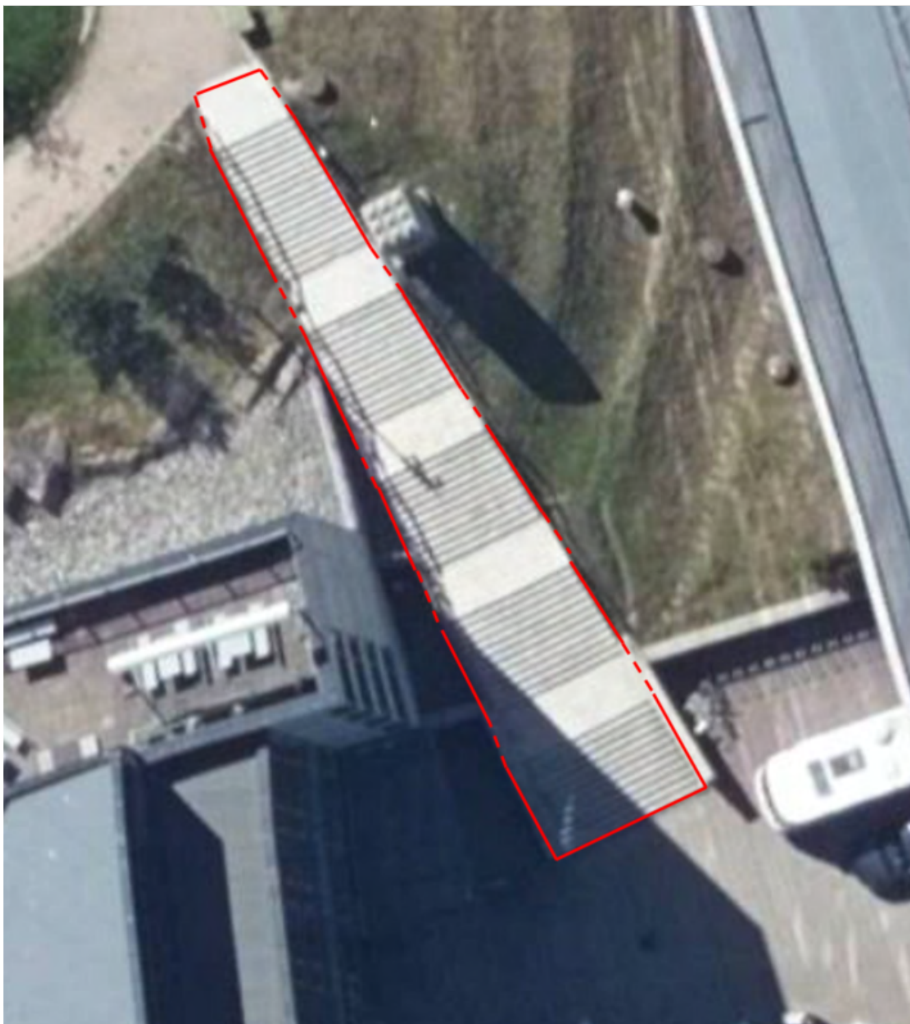
Figur 22. Eksempel på trapp som er delt inn i ulike nivåer. Rød helstrek viser de delene som er skrå/vertikale, rød stiplet viser horisontale deler av trappen.
