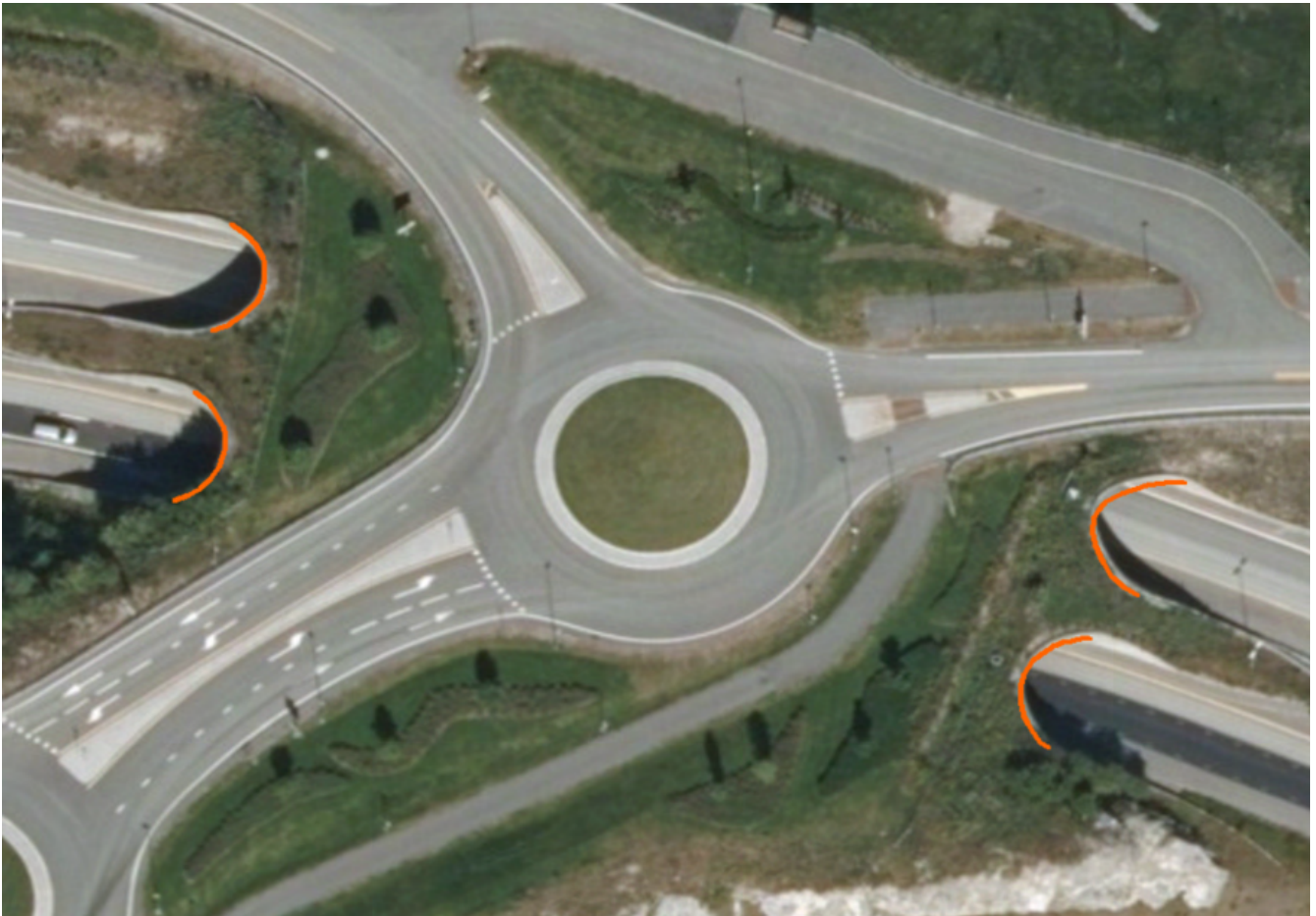
Figur 9. Illustrasjon fra produktspesifikasjon av Tunnelportal
