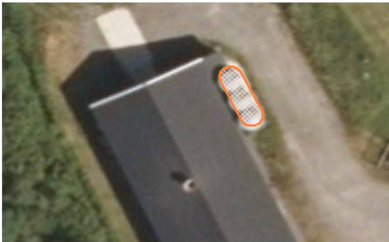
Figur 19. Når det er flere tanker ved siden av hverandre skal de registreres som et sammenhengende polygon, dersom det samlede arealet overstiger minstemål. Underste bilde viser tre tanker (hver enkelte Tank under minstemål) som skal registreres sammenhengende ettersom det samlede arealet overstiger minstemål.
