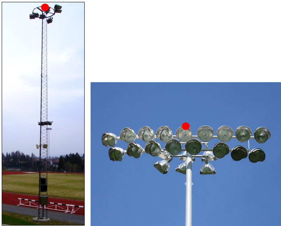
Figur 1: Eksempel på forenkling av registrering av et EL_Belysningspunkt. Masten registreres ved et punkt i topp mast (rødt punkt). Fotavtrykket til masten (EL_Belysningspunktet), eller det enkelt armatur registreres ikke.
