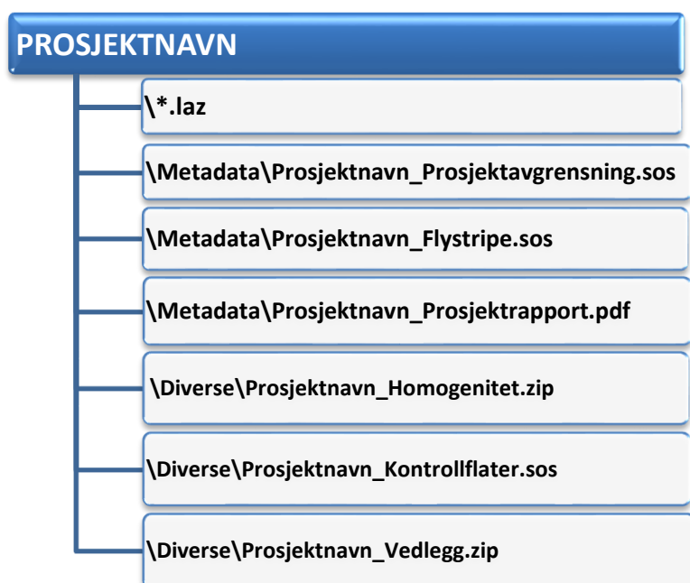
Figur 5 Struktur for leveranse av data fra laserskanning
