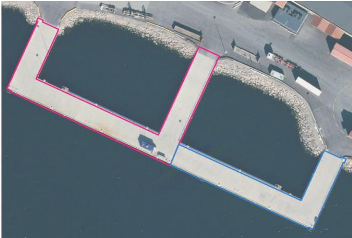
Bilde 7: Bildeeksempel av Lastbegrensningsgrense. I eksempelet, der lastbegrensningsområdet er oppå kaia blir høydereferanse: Topp, tilsvarende som for kaifrontområde. Hadde lastbegrensningsområdet befunnet seg lenger inn på kaia vil høydereferanse: fot være naturlig å bruke. Eksempelet er ikke avsjekket med virkeligheten. Norkart, 2020.
