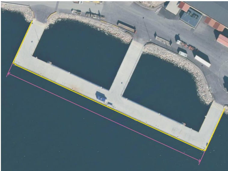
Bilde 4: Kaifront er lagt inn med gul linje. Kailengden måles opp på den delen av kaifronten som egner seg for anløp av skip. Høydereferanse: Topp. Norkart, 2020.
