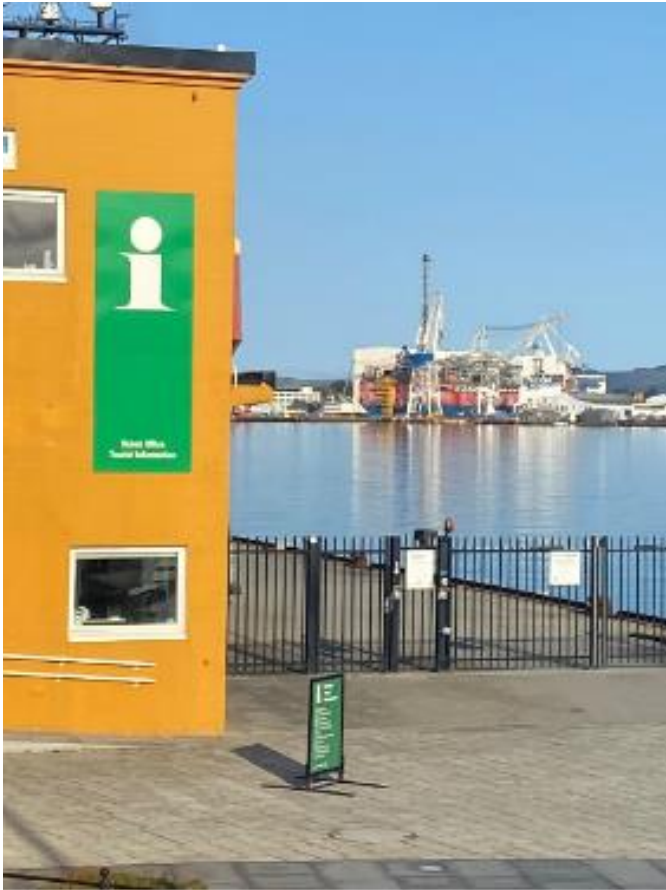
Bilde 2: Et havnesikkerhetsområde kan avgrenses av f.eks. bygning, havnegjerde og kaifront, slik som vist i eksempelet ovenfor. HavnesikkerhetsområdeGrense måles opp med utgangspunkt i geometrien til disse objektene. Høydereferanse: Fot. Stavanger havn, 2020.
