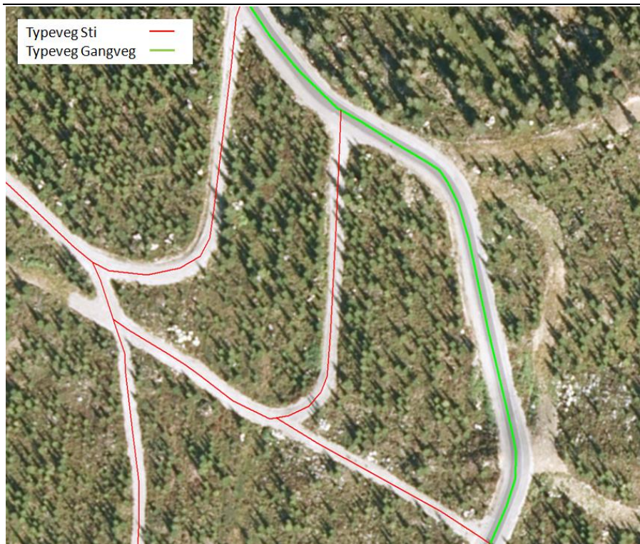
Figur 5: Eksempel på registrering av Typeveg Gangveg i utmark. Veg med fast dekke (her rulleskiløype) registreres som gangveg. Opparbeida traseer for skiløyper uten fast dekke kan vurderes registrert som sti eller traktorveg ut fra graden av opparbeiding og bruk.
