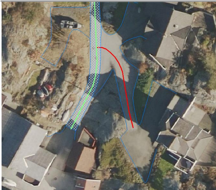
Figur 8: Eksempelet viser en eksisterende Veglenke (rødt) som ikke skal slettes (selv om den ikke oppfyller kriteriene for fotogrammetrisk registrering) ettersom vegen fortsatt eksisterer og er kjørbær i bildene. I dette tilfellet skal det ikke registreres vegflate i FKB-Veg (inkonsistens mot Vegnett tolereres).
