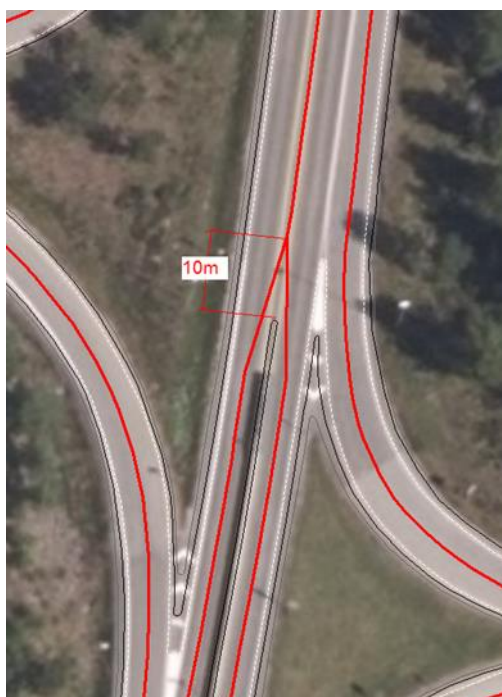
Figur 3: Øverst til venstre: Kanalisert veg 4-felt. Øverst til høyre: Kanalisert veg 3-felt. Nederst: Overgang Enkel bilveg 2-felt til Kanalisert veg 2-felt.
