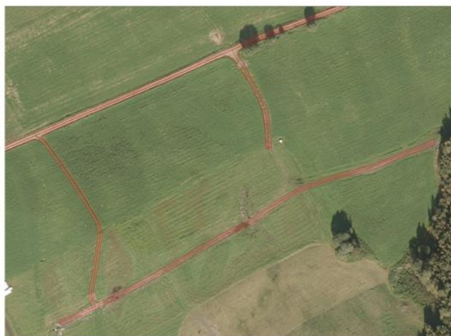
Figur 6: Eksempel på feilaktig registrering av kjørespor som Typeveg Traktorveg (rød strek) til venstre og korrekt registrering til høyre.
