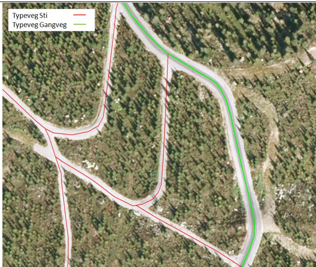
Figur 7: Eksempel på registrering av Typeveg Gangveg i utmark. Veg med fast dekke (her rulleskiløype) registreres som gangveg. Opparbeida traseer for skiløyper uten fast dekke kan vurderes registrert som sti eller traktorveg ut fra graden av opparbeiding og bruk.
