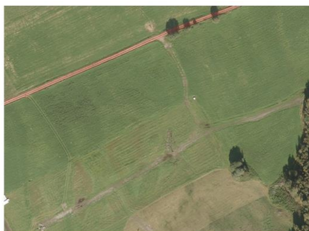
Figur 6: Eksempel på feilaktig registrering av kjørespor som Typeveg Traktorveg (rød strek) til venstre og korrekt registrering til høyre.
