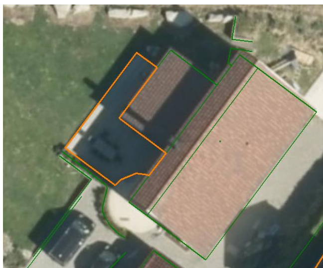
Figur 32: Plattinger (oransje) uten rekkverk og som ligger på terrenget eller mindre enn 40cm over terrenget skal ikke registreres som veranda.
