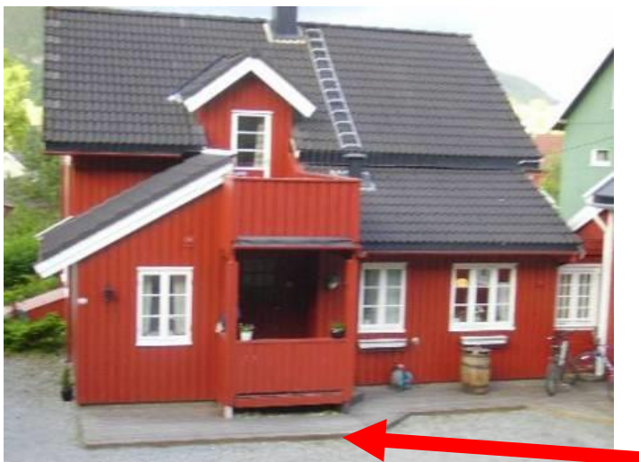
Figur 31: Plattinger uten rekkverk og som ligger på terrenget skal ikke registreres som veranda.
